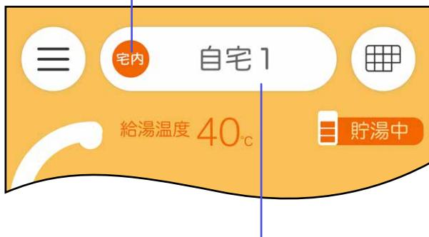
スマートフォンを複数の給湯機器に接続している場合、タップして「自宅モード」と「見まもりモード」を切り替えたり、操作したい給湯機器を切り替えたりできます→[P56](#)
