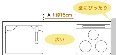
※コンロ側の壁の構造は、有効な防火措置構造壁対応、または防熱板設置が必要です。
