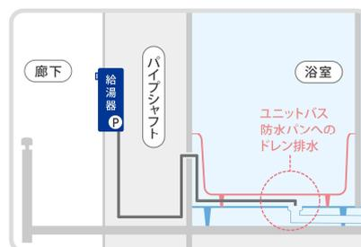
ドレン水を専用配管と機器内のポンプで排水
