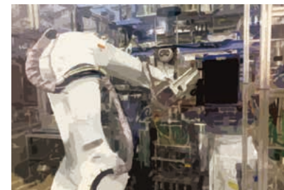
生産実行システムと連携された自働検査ロボット
